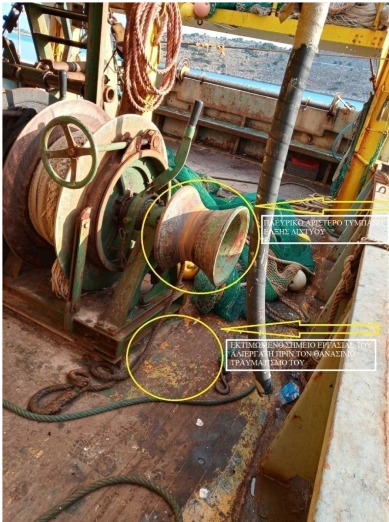
Εικόνα 4: Απεικόνιση εξαρτήματος του μηχανισμού έλξης του δικτύου που χρησιμοποιούσε το Α/Κ "ΑΓΙΟΣ ΙΩΑΝΝΗΣ ΙΙ'" το οποίο προκάλεσε τον θανάσιμο τραυματισμό του Αλιέα.
